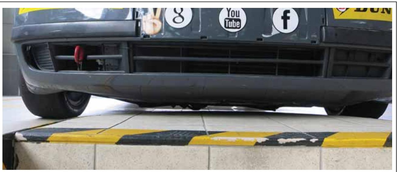
Slika 4.1. Zbog „sniženog ovjesa“, donji dijelovi motora i ovjesa zapinju za zaobljeno uzdignuće i povišene rubove kanala. Prije nego što se vozilo sa sniženim ovjesom uveze na tehnološku liniju, obavezno provjeriti izbočene dijelove motora i ovjesa koji bi mogli zapeti.
