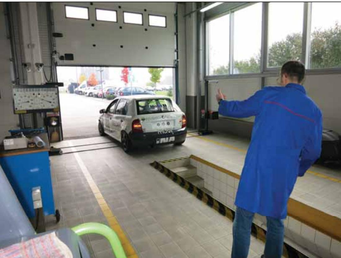
Slika 4.2. Uvođenje vozila kroz izlaz STP unatrag jer izlaz iz kanala nije opremljen zaobljenim uzdignućem.
